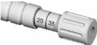
Пример установки крутящего момента, равного 20 Н·см
