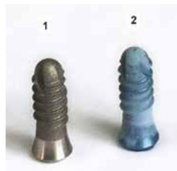
Рис. 5. Дентальные имплантаты после выдержки в растворе DPBS в течение 2 недель: 1 — титановый имплантат без покрытия; 2 — имплантат с покрытием TiO<sub>2</sub> (анатаз) и сформировавшимся слоем гидроксиапатита
